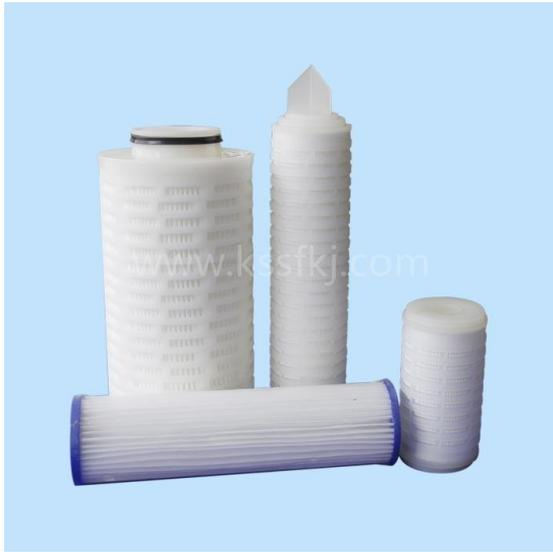
滤芯采用聚丙烯、聚醚砜、聚四氟乙烯、尼龙热熔纤维膜固定在聚丙烯骨架内制成聚丙烯折叠式滤芯用于液体的预过滤，澄清过滤及终端过滤。具有过滤面积大，使用寿命长等特点。是一种具有良好的深层过滤效果的滤芯。采用聚丙烯结构，利用超声热熔粘结工艺生产无二次污染，具广泛的化学相容性，过滤精度范围 0.1-75 $\mu$  m 之间。常规接口有 222、226、平压式三种，特殊规格可订做。
